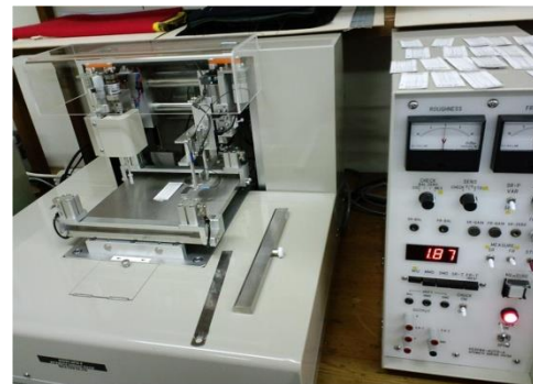
図 2 毛髪の滑り試験装置
